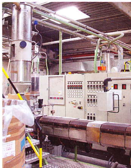
Beheizter Zylinder in dessen Innerem sich eine Förderschnecke befindet.
