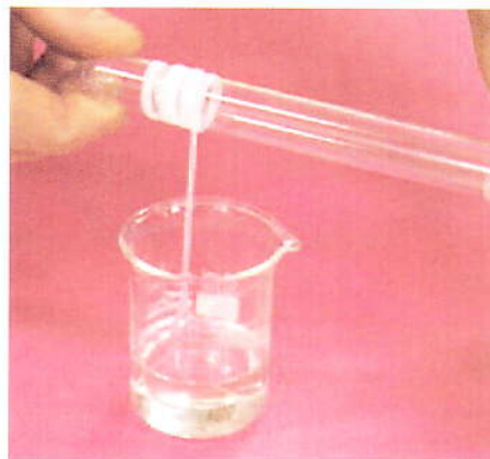
Herstellung eines Nylonfadens
