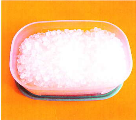
Polyethengranulat: Die oben abgebildete Menge ist erforderlich, um die unten abgebildete Dose im Spritzgussverfahren herzustellen.
